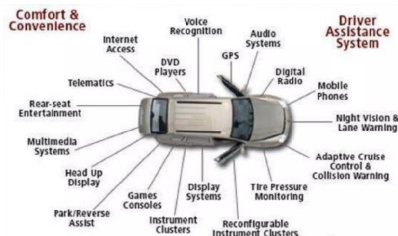
Figure 2 – Une illustration des différentes fonctionnalités / caractéristiques d'une voiture connectée
